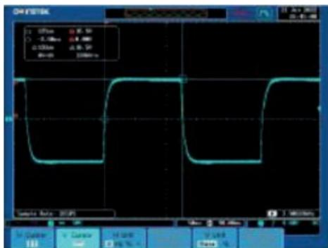
Forma de onda simétrica de un multi-pulso (C1)
