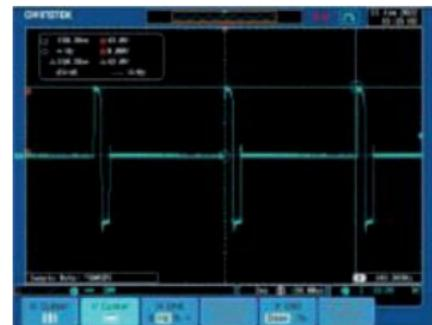
Forma de onda asimétrica de un solo pulso
