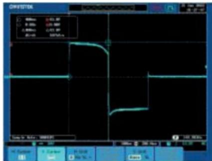
Forma de onda simétrica de un multi-pulso
