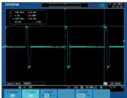
Forma de onda asimétrica de un solo pulso
